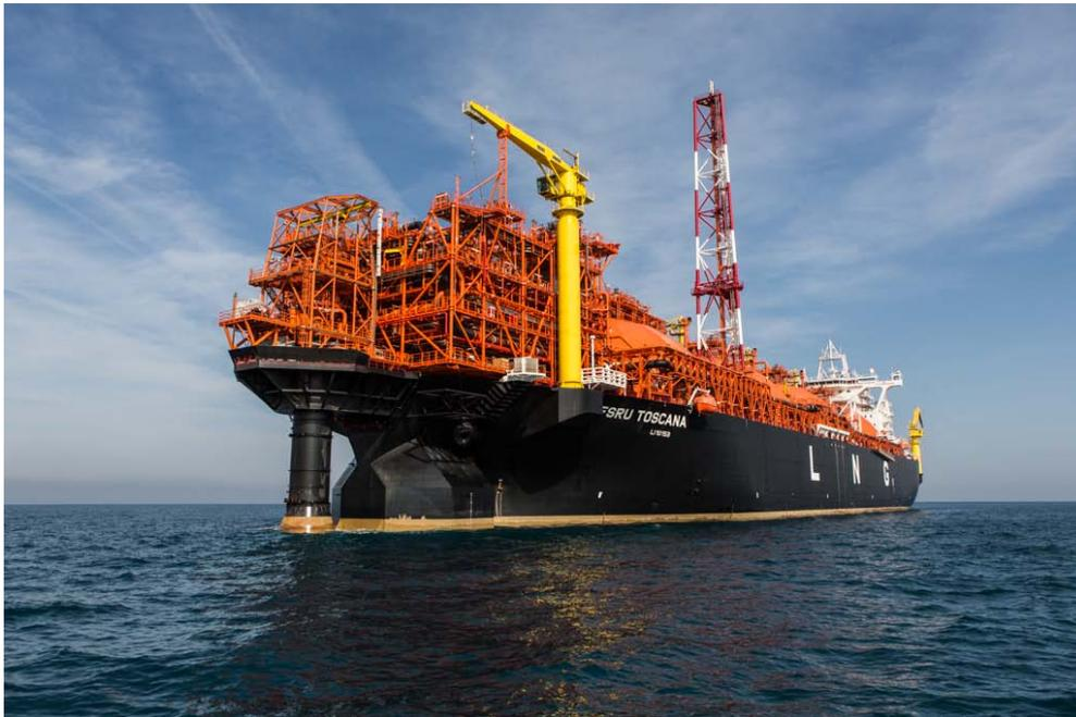
**OLT Offshore LNG Toscana S.p.A.** ha sviluppato e realizzato il Terminale di rigassificazione "FSRU TOSCANA", del quale detiene la proprietà e la gestione. Il Terminale è stato posizionato al largo delle coste toscane, a 22 km di distanza, e collegato alla terra ferma da una condotta di circa 30 km necessaria all'invio del gas naturale alla rete di distribuzione nazionale italiana.
