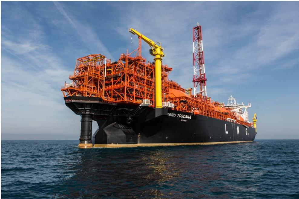
**OLT Offshore LNG Toscana S.p.A.** ha sviluppato e realizzato il Terminale galleggiante di rigassificazione “FSRU Toscana”, del quale detiene la proprietà e la gestione commerciale. Il Terminale è ormeggiato a circa 22 chilometri al largo delle coste tra Livorno e Pisa ed è collegato alla terraferma da una condotta sottomarina necessaria all’invio del gas naturale alla rete di distribuzione nazionale italiana.
